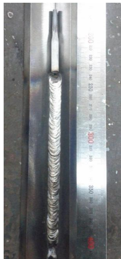
Положение сварки РВ (вертикальное снизу- вверх), DC+ 130~140А
